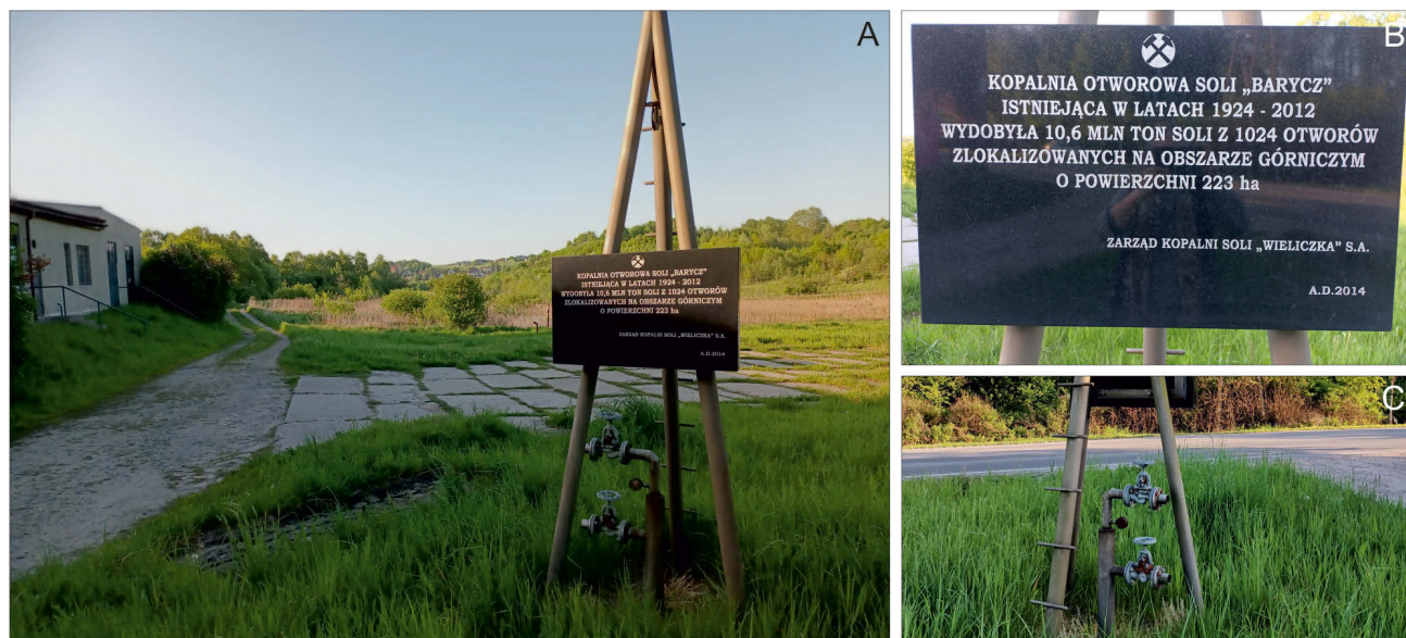
Ryc. 3. Pomnik upamiętniający kopalnię otworową Barycz. A) Trójnóg eksploatacyjny w formie ostrostłupa montowany nad otworem wiertniczym (fot. J. Świąchowicz); B) Tablica informacyjna upamiętniająca byłą kopalnię (fot. J. Świąchowicz); C) Dwa zawory i zegar wchodzące w skład uzbrojenia otworów wiertniczych (fot. J. Świąchowicz)
