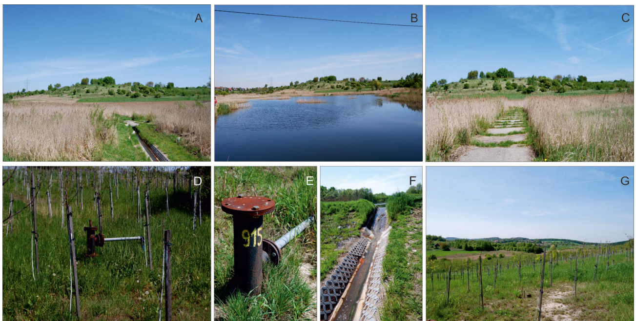
Ryc. 11. Pole Pagory w 2014 r. (fot. J. Świąchowicz) A. Dno doliny Malinówki i wzniesienie w NE części pola; B. Sztuczne jezioro utworzone w dawnym zapadlisku; C. Jedna z utwardzonych dróg dojazdowych; D. Fragmenty rurociągów, którymi odprowadzano solankę; E. Jeden z odwiertów, którym tłoczono wodę pod ziemią w celu rozpuszczenia pokładu soli; F. Uregulowane i obudowane koryto Malinówki; G. Obszar zrehabilitowanego Pola Pagory z widocznymi nasadzeniami drzew
