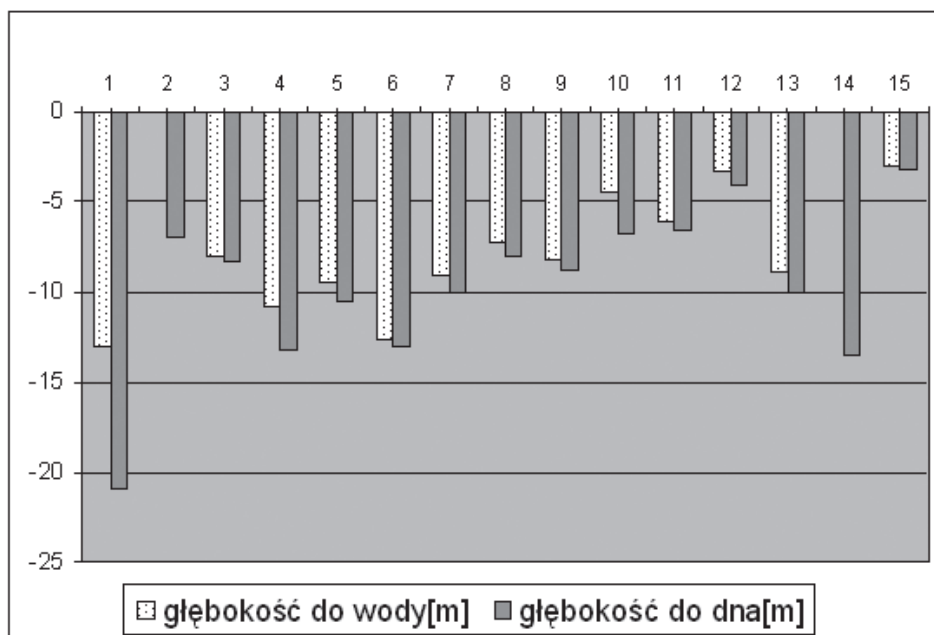
Ryc. 5. Głębokość do dna studni i do lustra wody w czasie badań prowadzonych w marcu 2005r.
